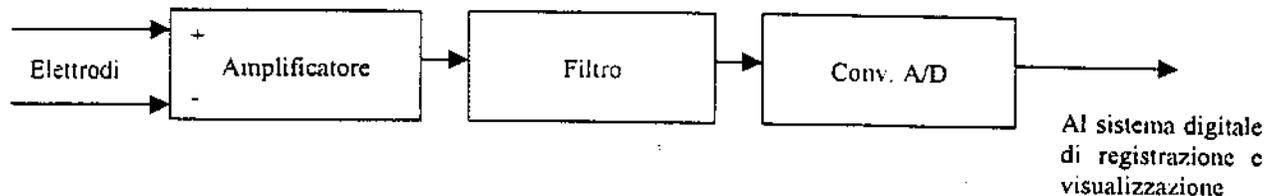
Il segnale elettrico, proveniente dai due elettrodi applicati al paziente, si presenta all'amplificatore in modo differenziale ed ha valore compreso fra  $-0.8$  mV e  $+0.8$  mV con componenti armoniche significative in banda  $0.1 \div 40$  Hz. Detto segnale è disturbato dalla tensione di rete a 50 Hz presente nell'ambiente.
