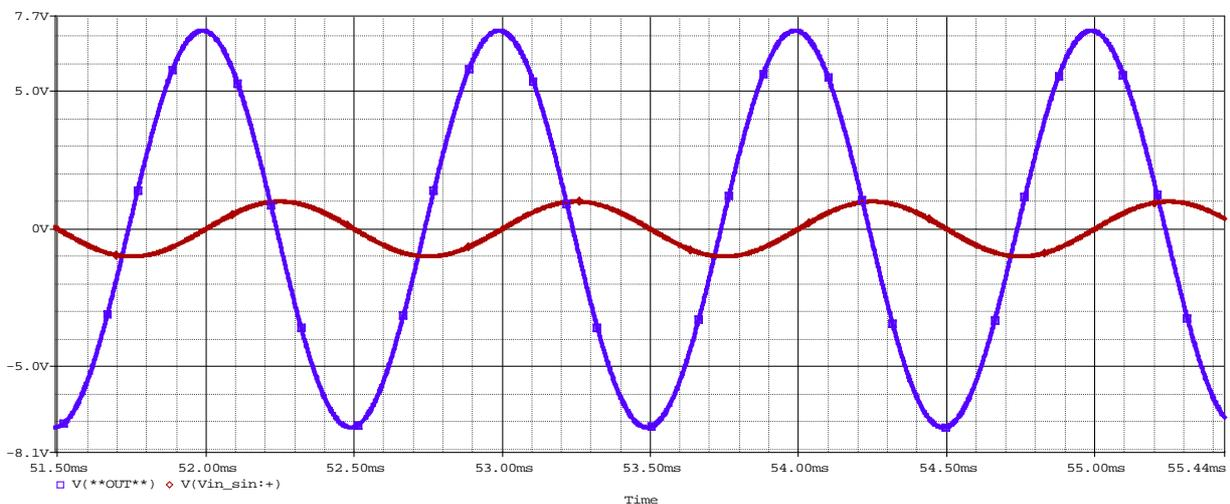
per dedurre dal grafico dell'uscita quale sia l'integrale di un seno, manipolo le curve ottenute: inverto l'uscita e la amplifico e 'zoommo' in modo da avere il seno di ingresso che parte dall'origine. Il risultato è il seguente:
