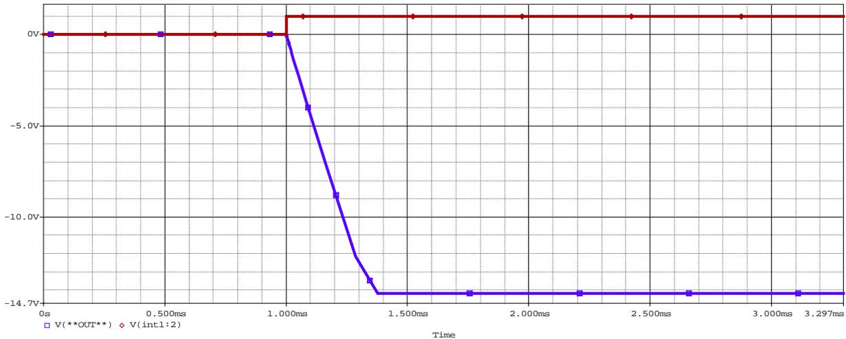
Ad 1ms si aprono e chiudono i vari interruttori, la tensione di ingresso, in figura, è di +1V, dopo  $\cong 0.3 \div 0.4$ ms l'uscita è in saturazione negativa ( $\cong -14$ V). La tensione di ingresso è un gradino unitario di tensione, la sua trasformata di Laplace è come noto:
