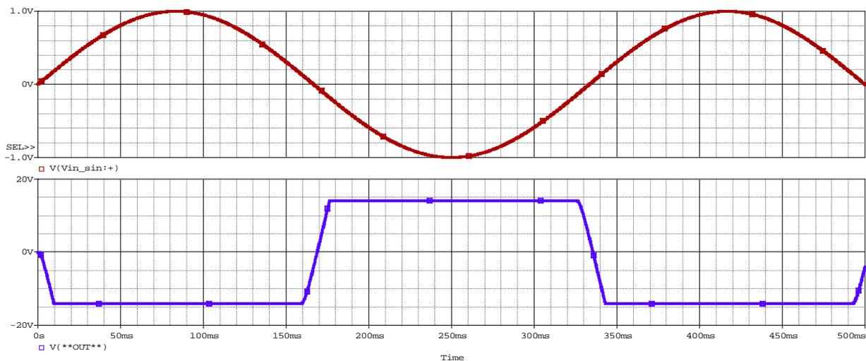
In definitiva l'integratore ideale rischia di finire in saturazione a causa di disturbi a bassa frequenza ed alla presenza di piccoli off-set indesiderati. Si ricorre allora all'integratore reale.
