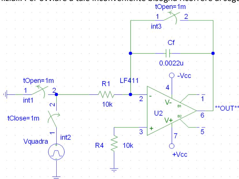
Gli interruttori 1 e 3 si aprono e l'interruttore 2 si chiude dopo 1ms; int.3 serve a scaricare il condensatore prima dell'inizio della misura, int.1 ed int.2 ad escludere l'alimentazione (per la riuscita della simulazione sarebbe sufficiente il solo int.3!).
