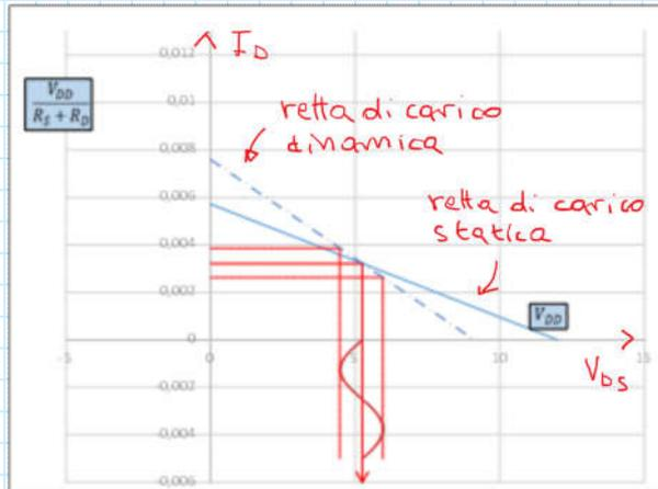
L'oscillazione di  $i_D$  causa una oscillazione di  $v_{DS}$  attorno  $V_{DSQ}$
